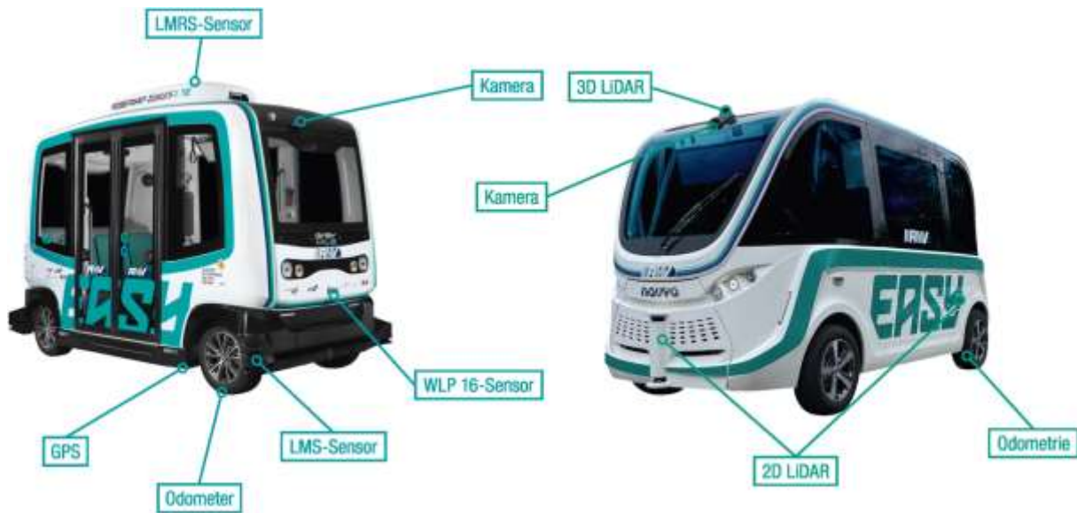
Bild 3 Sensoren am Fahrzeug EasyMile „EZ10 Gen 2“ und NAVYA „Arma DL3“ (Bild: RMV, Anpassung fahma)
