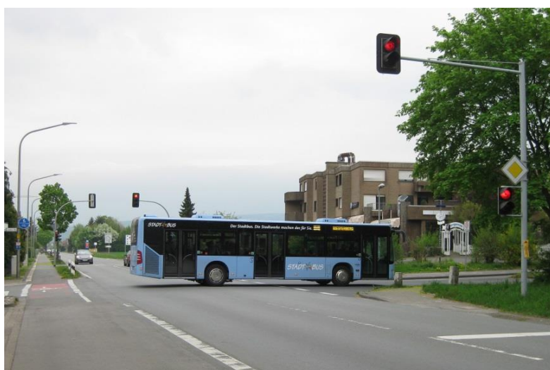
Abb. 10: Abfangsignalisierung an einer Hauptverkehrsstraße: Bus kann nahezu verlustzeitfrei queren (Beispiel: Lemgo)
