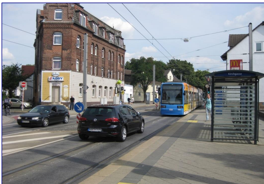
Abb. 11: „Dynamische Straßenraumfreigabe“: Tram befährt als Pulkführer den Straßenabschnitt mit straßenbündigem Bahnkörper, Zurückhalten des MIV mit Abfangsignalisierung am Beginn des Streckenabschnittes (Beispiel: Kassel)
